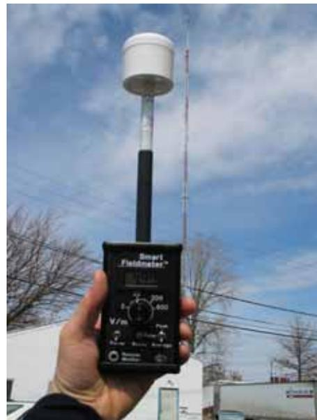
技术特点: 全向探头分离的便携式电磁辐射测试仪
